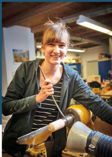
Kraftvoll zupacken: Hier wechselt eine Gesellin in der Firma Wagner (Hainichen) ein Drechsel-Werkzeug
