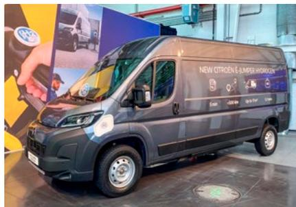
Batterie mit 110 kWh Kapazität. An Ladesäulen mit 22 kW Leistung dauert ein Ladevorgang etwa sechs Stunden. Mit dem Electric-Power-Take-Off soll es möglich sein, den Strom auch gezielt für Herd, Heizung oder Klimaanlage zu entnehmen.
