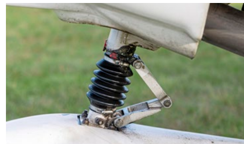
Der Bugrad-dämpfer fängt stärkere Stöße sanft ab.
